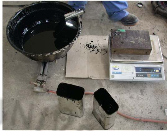
(d) Heating of Asphalt
