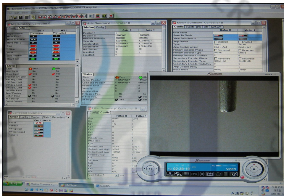
그림 57. 스테이지 구동 제어와 노즐 모니터링
