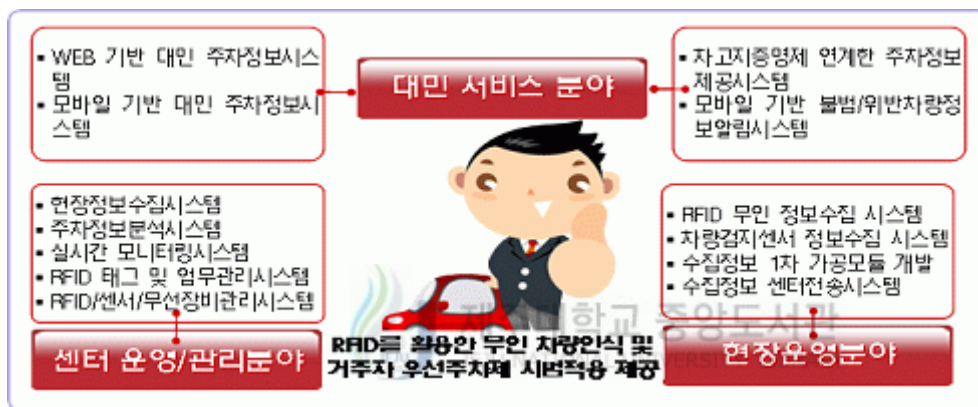
[그림 6] RFID와 모바일이 결합된 거주자우선주차시스템의 구성도
