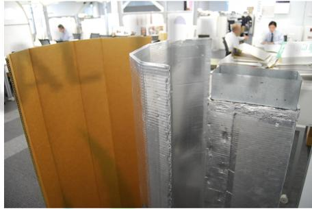
그림 3-12. 단열 및 내연성이 높은 알루미늄과 재생골판지를 이용한 방화재의 모습
