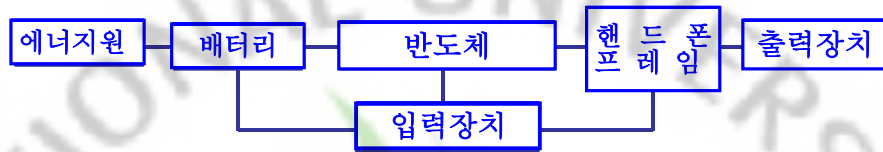
<그림 3-4> 기능을 “통화한다”로 정의할 때, 핸드폰의 구성
