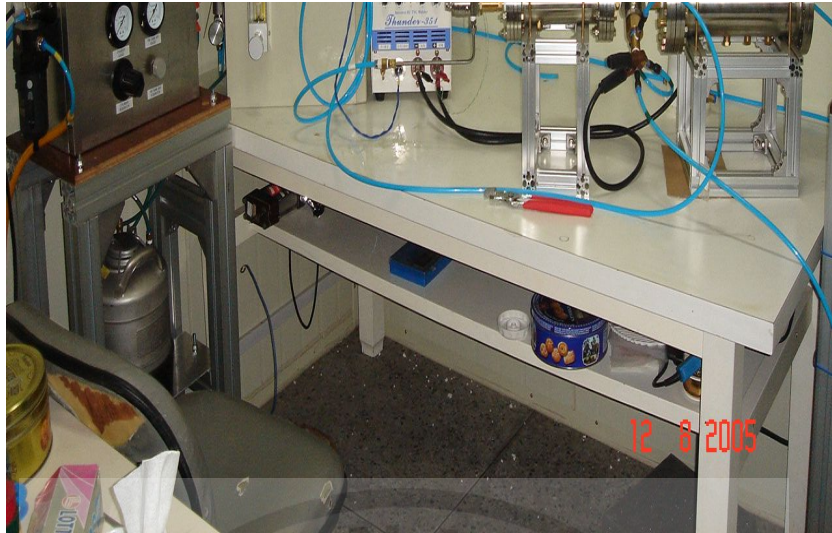
[그림 3-6] 최초 제작된 플라즈마트론 연료개질 시스템
