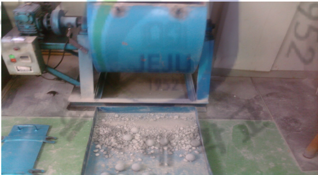
[그림 4.5] 굵은 골재 마모감량 시험
