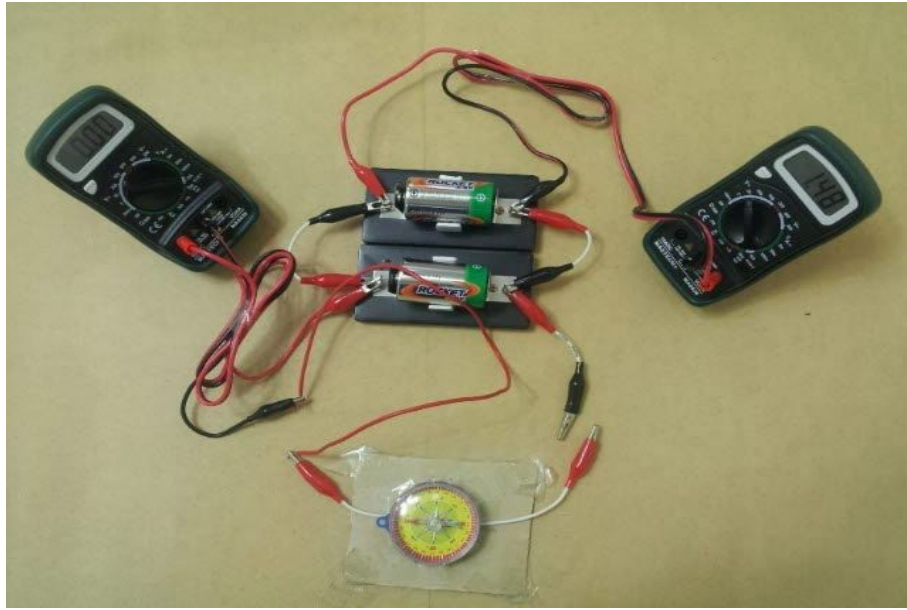
그림 IV-11. 부하저항이 전지의 내부저항보다 작은 영역에서 전지의 병렬연결 전기회로의 모습
