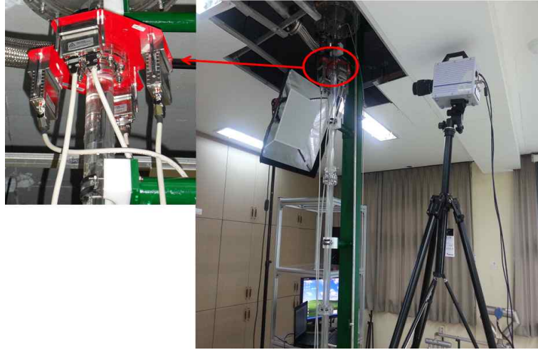
Fig. 20 WMS와 고속 카메라를 적용한 수직관
