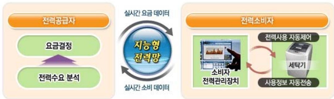
〈그림 2-3 스마트그리드 에너지절약 메커니즘(출처:스마트그리드사업단(재))〉
