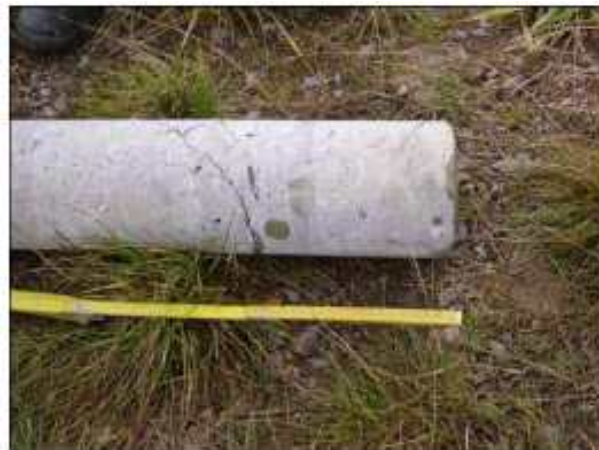
Fig. 22 이중 플랜지 앵커링 형식 기초하부 전달균열 콘크리트 시편[14]
