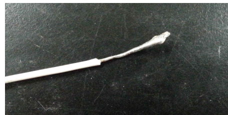
[그림 IV-16] 전선 끝 피복을 2 cm 정도 벗긴 후 납땜한 모습
