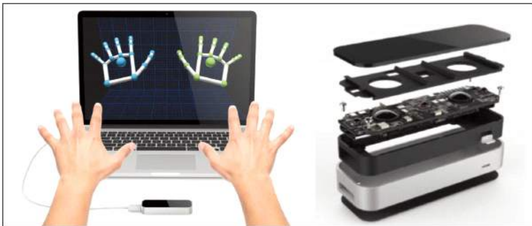
Fig. 2. 립모션을 통한 손가락 움직임 제어(좌)와 카메라 구조(우)
