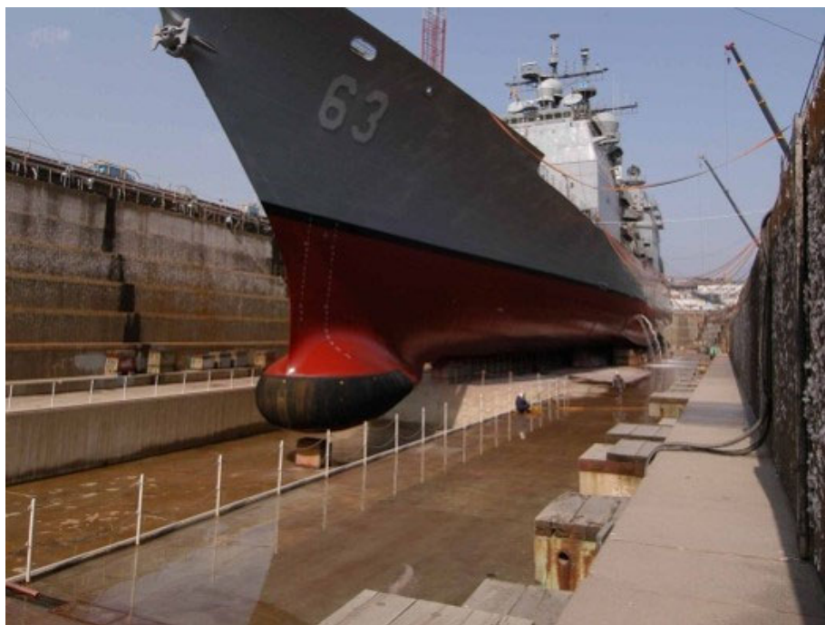
Figure 2. 해군 함정에 설치되어 있는 선저 고정형 소나 (Aselsan, 2019)
