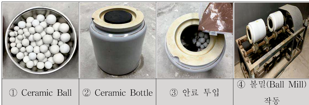
도33 볼밀(Ball Mill)을 이용한 안료 제작과정
