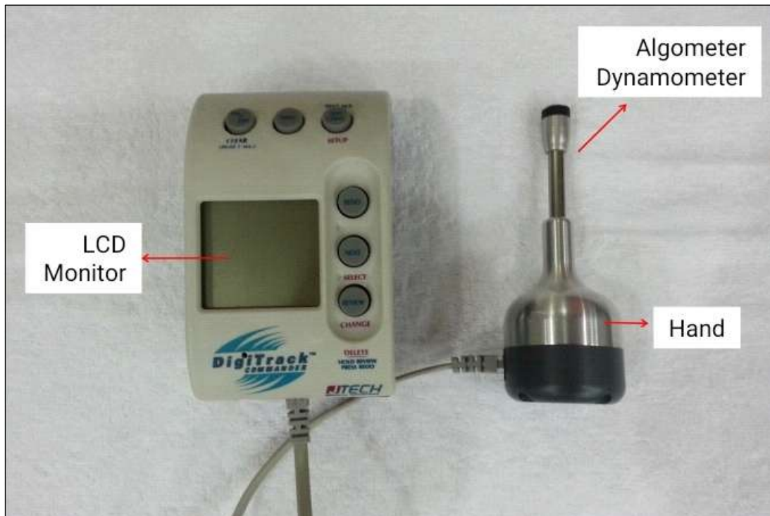
그림5. 본 실험에서 사용된 압력 통각계(Commander Algometer, J-TECH Medical Indust, USA)
