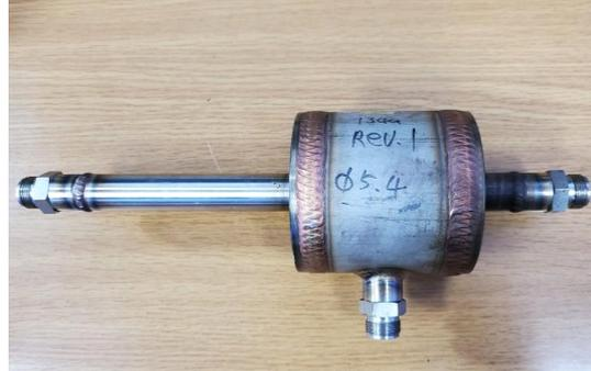
(d) Ejector nozzle size(mm) : 5.4
