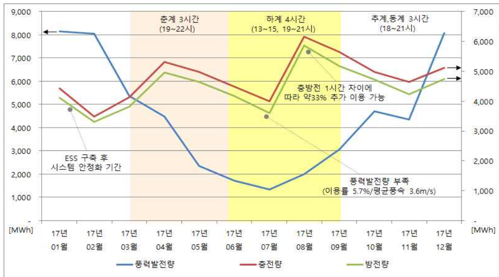
그림 14 2017년 동북·북촌 풍력발전단지 발전량 및 ESS 총·방전량
