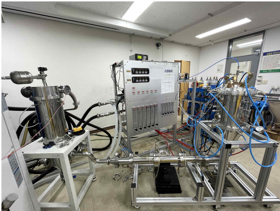
그림 4. 삼중 DC 열플라즈마를 활용한 메탄 열분해 시스템
