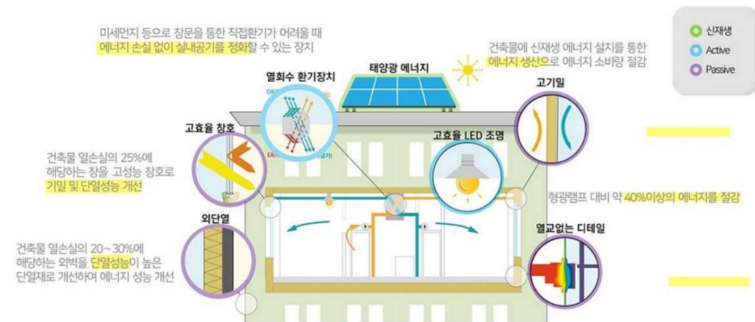
그림5 그린리모델링 적용 기술요소(2021년 국토교통부 보고서)
