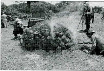
〈그림 13〉 측면부와 상부로부터 연기가 새는 모습
